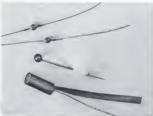
Bild 4. Zwei Subminiaturdioden der Howaldts-Werke im Vergleich mit einem Stecknadelkopf, das ein Germanium-Stromventil (Flächendiode)
