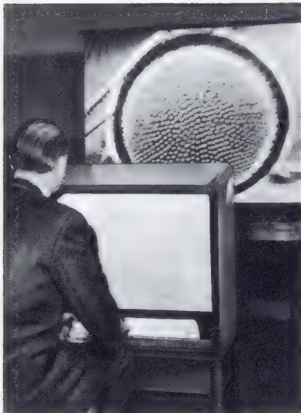
Bild 3. Philips-Fernsehprojektor VE 2600 bei der Übertragung von Mikroskopbildern
